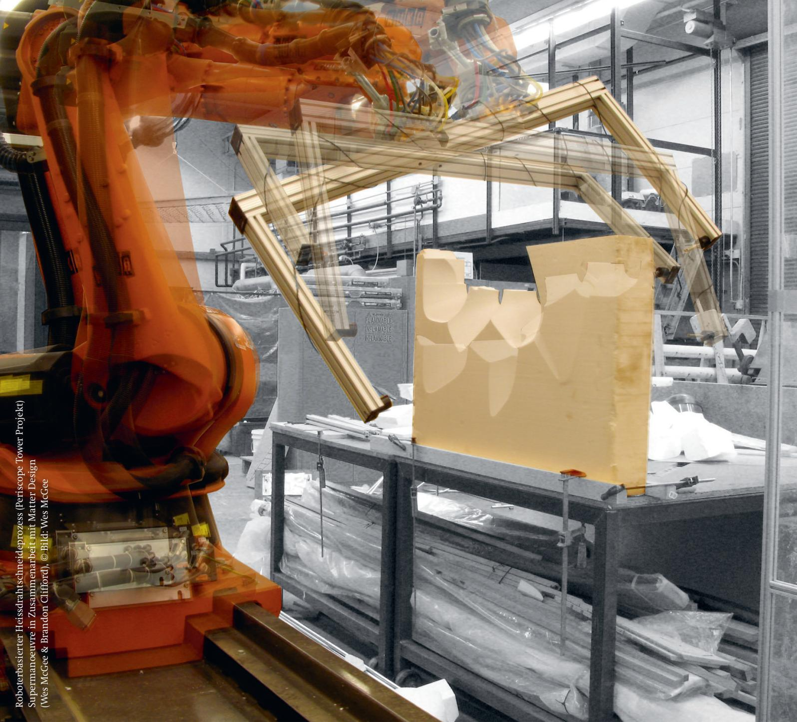
Roboterbasierter Heissdrahtschneidprozess (Periscope Tower-Projekt)
