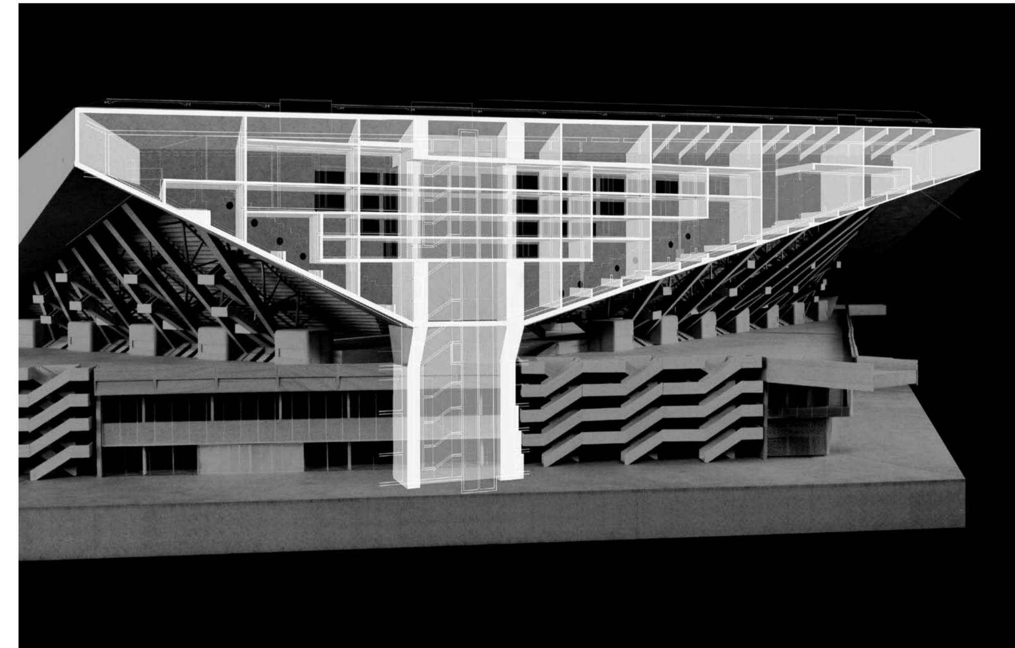
Axonometrie: ‚Kartenhaussystem‘ mit tragenden Scheiben
