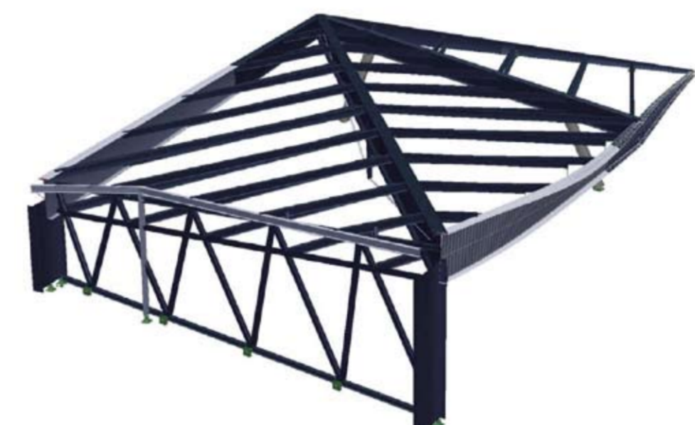
Räumliches statisches Modell (Kippen der Längsträger)
